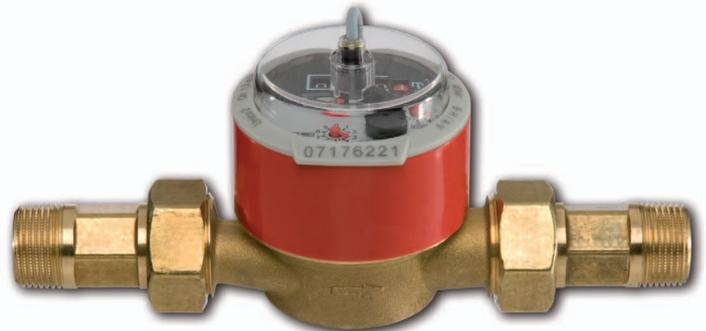
Das RESOL V40 ist ein Messgerät mit Kontaktgeber zur Erfassung des Durchflusses von Wasser oder Wasser-Glykolgemischen und wird häufig in Verbindung mit dem Wärmemengenzählermodul RESOL WMZ eingesetzt. Nach dem Durchströmen einer definierten Durchflussmenge gibt das V40 einen Impuls an den Wärmemengenzähler ab. Aus diesen Impulsen und einer gemessenen Temperaturdifferenz berechnet der WMZ anhand definierter Parameter (Glykolart, Dichte, Wärmekapazität usw.) die genutzte Wärmemenge.
