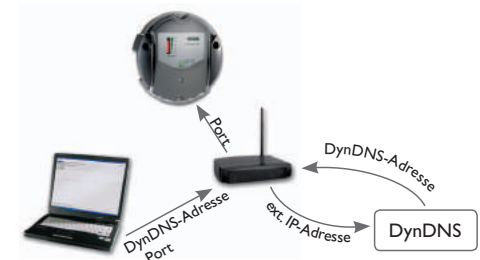
Schematische Darstellung: Fernzugriff auf den DL2, Router mit DynDNS Adresse
