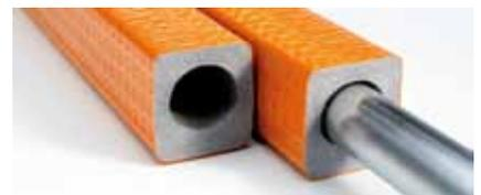
Rohrisolierung aus geschlossenzelligem Schaum auf Basis von Polyethylen mit exzentrischer Rohrführung und robuster Außenhaut für die Isolierung von Heizkörperanschlussleitungen im Fußbodenbereich.
