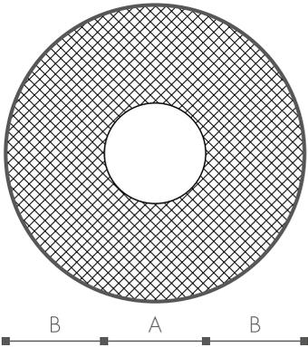
CLIMAFLEX® STABIL ist mit einer robusten Außenhaut versehen, die den Schaum vor Beschädigungen schützt, so dass die Isoliereigenschaften des Produktes selbst unter rauen Baustellenbedingungen gewährleistet werden können.
