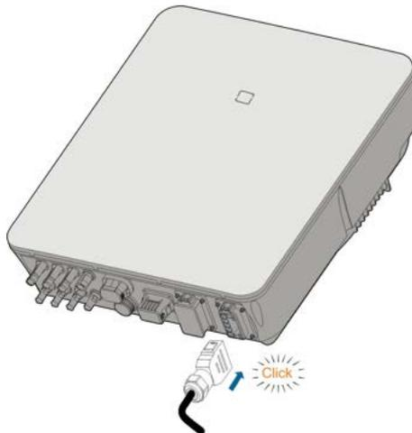
**Schritt 4 (Optional)** Führen Sie den Block wie in der unteren Abbildung gezeigt ein.
