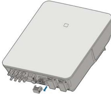
**Schritt 2** Stecken Sie den COM-Stecker in die **COM**-Klemme an der Unterseite des Wechselrichters, bis ein akustisches Geräusch (Klicken) zu hören ist.
