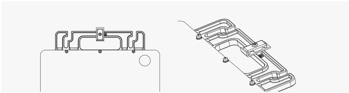
Verlegen Sie für jeden Mikrowechselrichter ein durchgehendes Erdungskabel durch die Erdungswinkel zur den örtlichen Vorschriften entsprechenden AC-Erdungselektrode.
