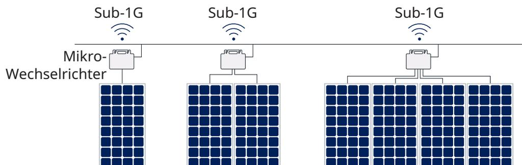
In diesem Handbuch geht es um einen 4-in-1-Mikro-Wechselrichter von Hoymiles. Mit einer Ausgangsleistung von bis zu 2000 VA zählt Hoymiles neue Mikro-Wechselrichter-Serie HMS-2000 zu den leistungsstärksten 4-in-1-Mikro-Wechselrichtern.
